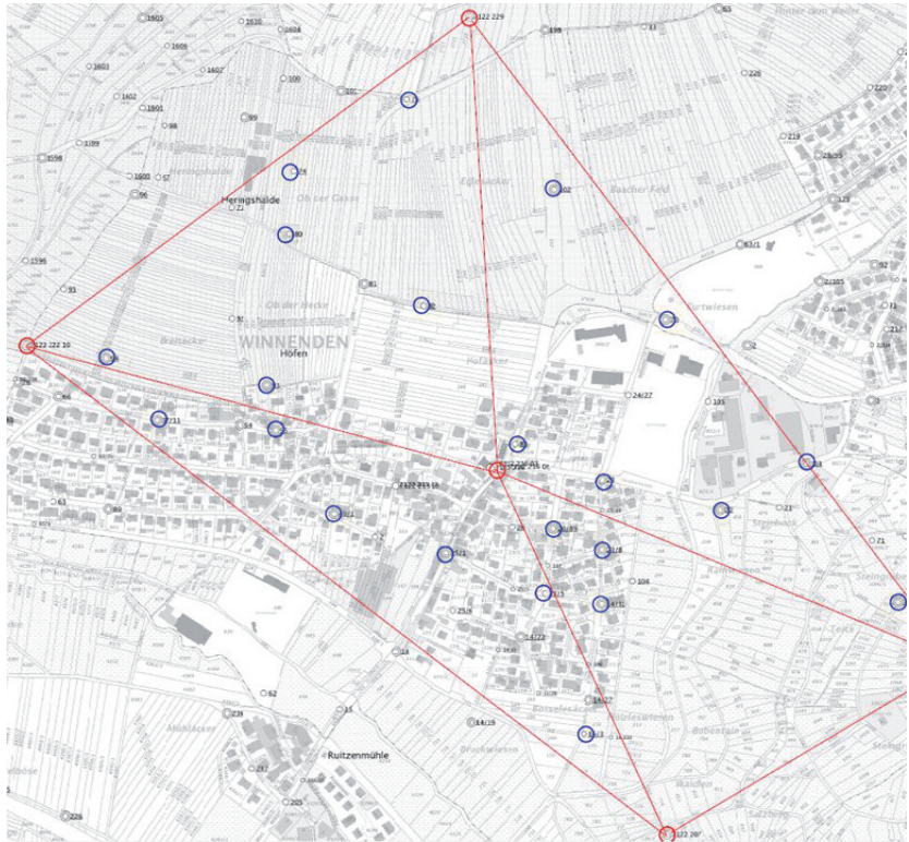
Abb. 23: Beispiel zur Passpunktauswahl - TP-Masche
